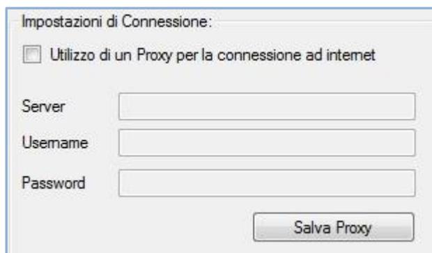
Se non si dispone dei parametri di configurazione rivolgersi al proprio tecnico di fiducia. Nel campo *Server* del Proxy è possibile indicare: "IP Server:Porta" (esempio 10.11.70.1:80).
